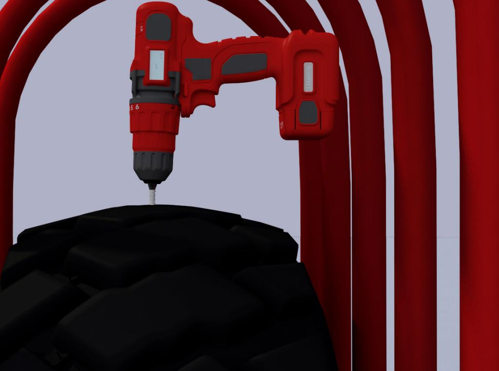
Une fois que le pneu atteint la pression de ventilation recommandée, un trou est percé à une position à 12 heures. Une aiguille de ventilation est ensuite insérée pour purger l'air résiduel du pneu.
