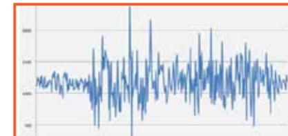
L'essai d'un Pneu Alvéolé montre 3 pics sévères de force G en 3 minutes. Cela équivaut à 480 impacts sur un poste de 8 heures.
