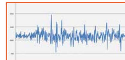
L'essai d'un Pneu Rempli à la Mousse montre 19% de force G en moins sur la cabine et pour le chauffeur et 17% de force G en moins sur l'essieu et l'équipement.
